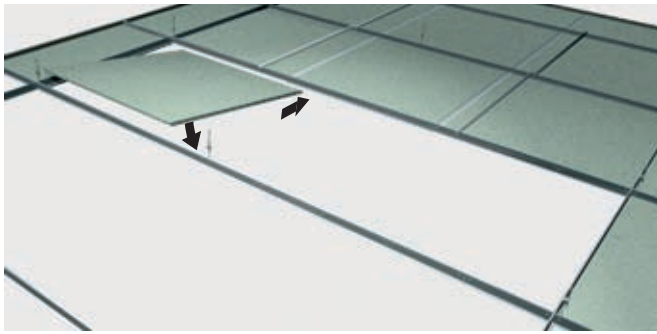
Stap 1: Paneel 1 met D2-kantafwerking over hoofdprofiel schuiven en de D1-kantafwerking op overliggend hoofdprofiel laten zakken.
